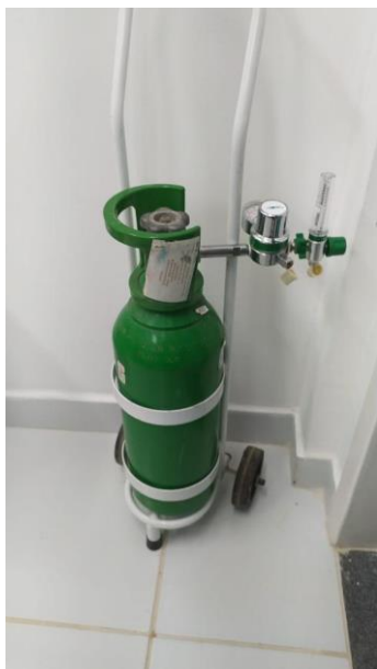
FOTO 20: Cilindro Oxigênio no posto de enfermagem
