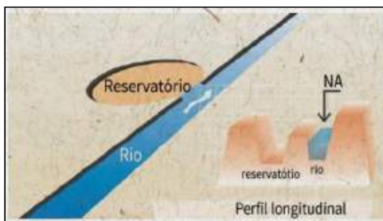
Figura 14 - Esquema de um reservatório fora de linha
