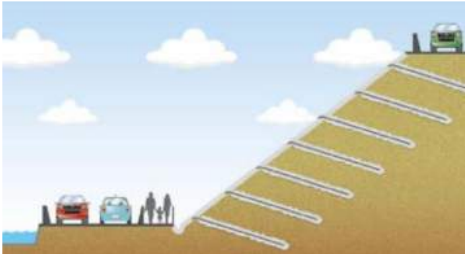
Figura 24 - Esquema de um grampeamento de solo em uma encosta
