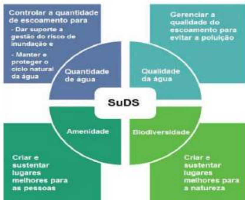
Figura 15 - Princípios dos sistemas sustentáveis de drenagem urbana
