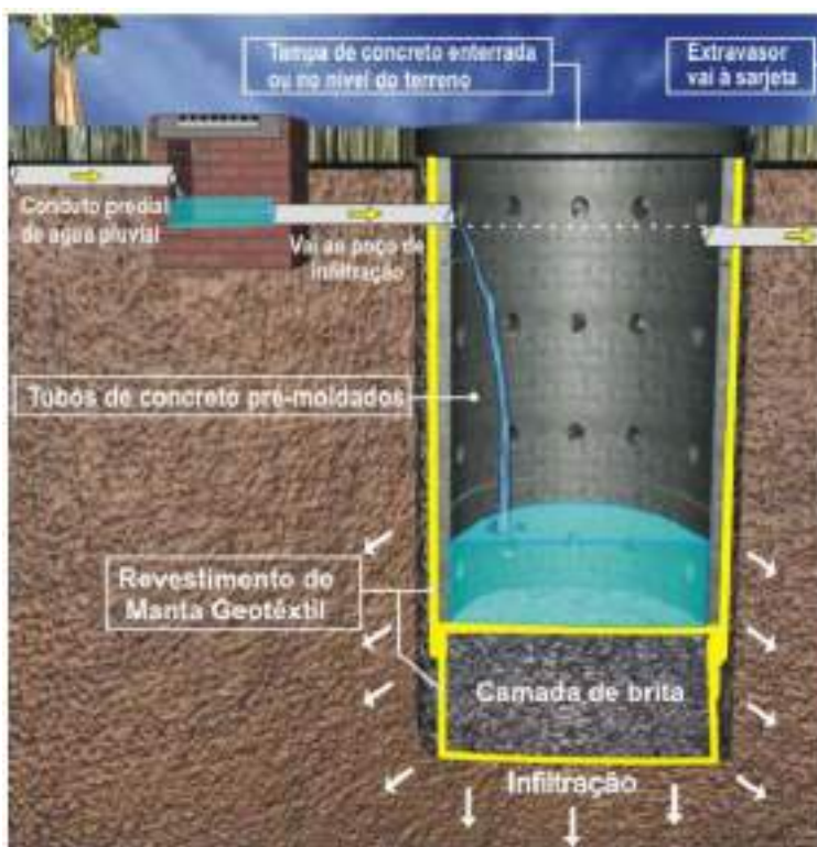
Figura 18 - Esquema de um poço de infiltração
