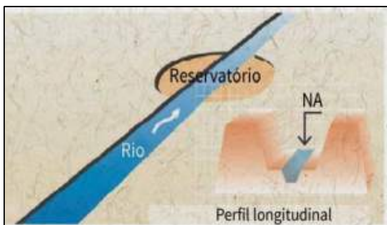
Figura 13 - Esquema de um reservatório em linha
